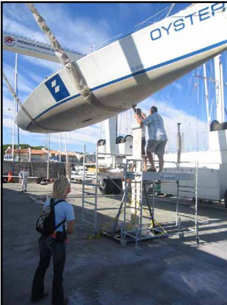
Le bateau (Psaros 40) va être descendu sur la quille oscillante. Celle-ci est actionnée par des vérins hydrauliques situés dans la coque.
